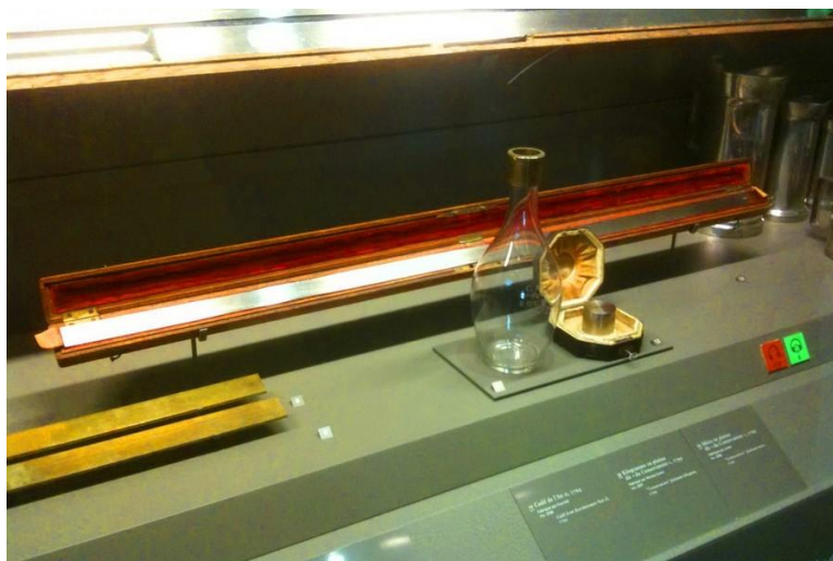
Рис. 3. Эталонный метр в Парижской палате мер и весов
