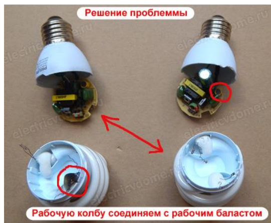
Рисунок 9 – Замена элементов лампы
