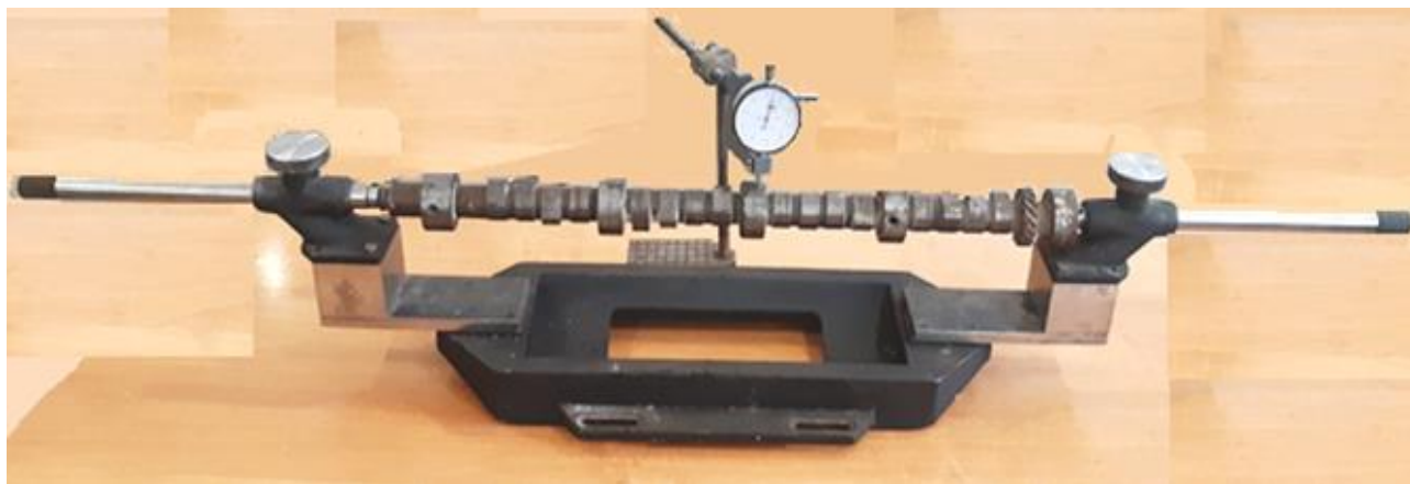
Рисунок 2 – Конструкция предлагаемого по проекту приспособления для контроля биения
