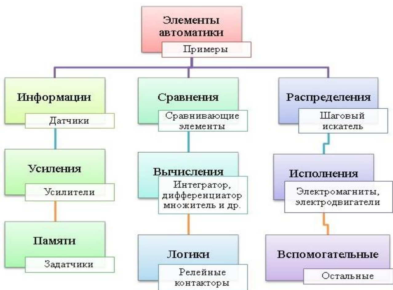
Рисунок 1 - Классификационная схема элементов автоматики по функциональным признакам с примерами
