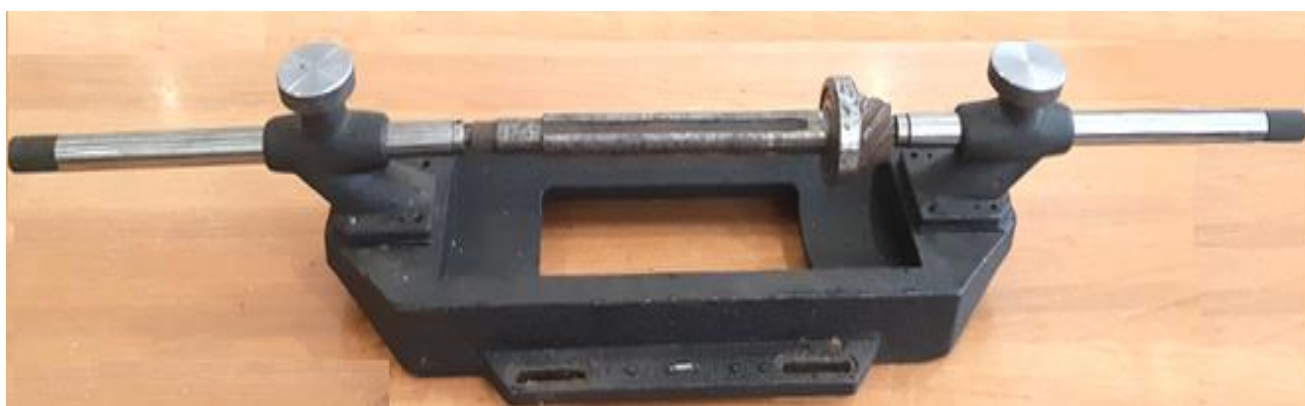
Рисунок 1 – Конструкция имеющегося приспособления для контроля биения
