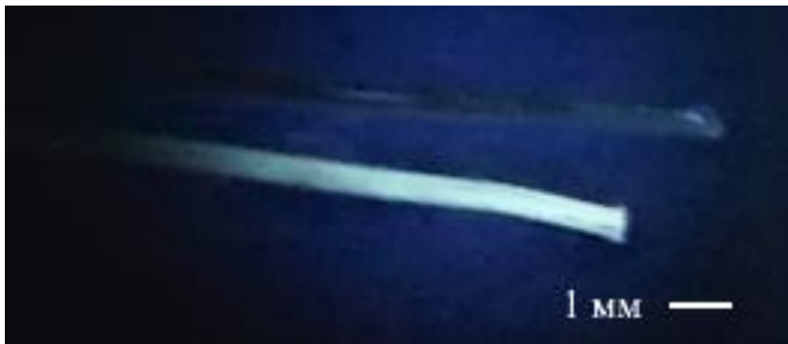
Рис. 3. Изображение фотолюминесценции оксидных пленок Al после высоковольтного анодирования при 1,2 kV в ЭТЛ (снизу) и при 2 kV в ОКТЛ (сверху). Описание в тексте
