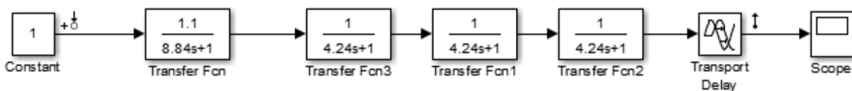
Рис. 31. Структурная схема модели объекта, аппроксимированная по методу В. Я. Ротача
