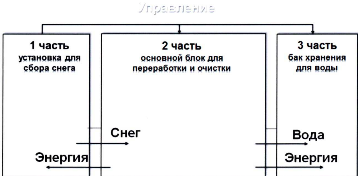
Рисунок 2.1. Принципиальная схема комплекса
