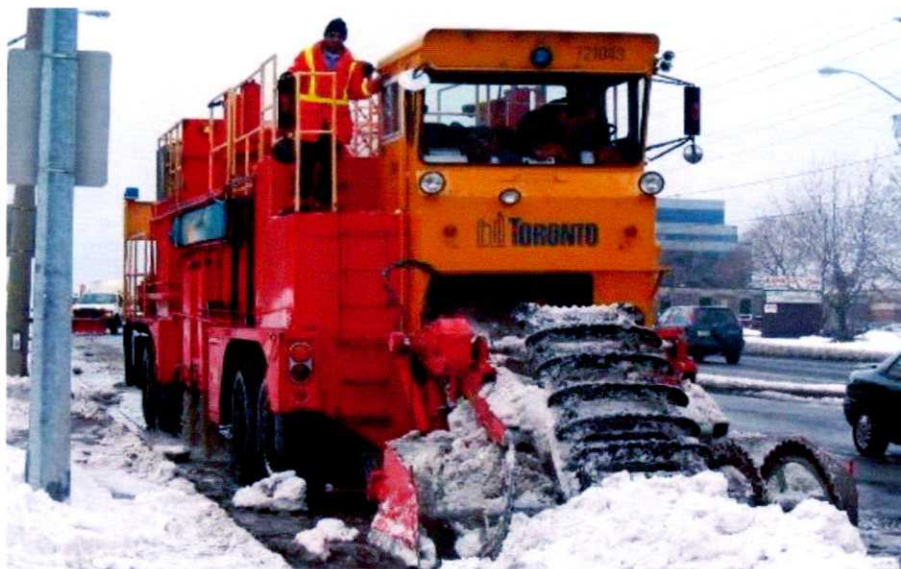
Рисунок 1.8. Самоходная снеготаялка типа «Metromelt»
