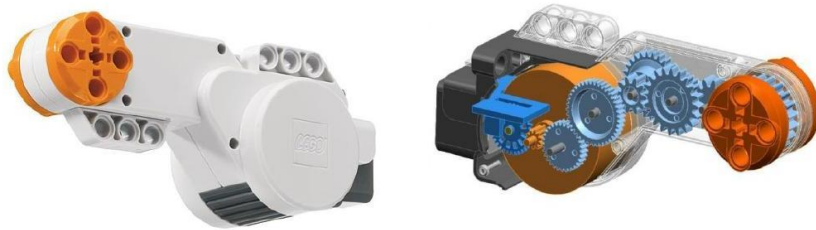
Рис. 2.1. Сервопривод (слева) и его внутреннее устройство (справа)
