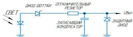
ПРИМЕР СИСТЕМЫ ПИТАНИЯ БЕЗ АККУМУЛЯТОРА
